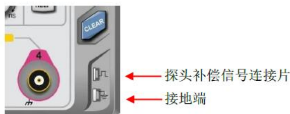
图 4-1 探头补偿信号连接片和接地端
