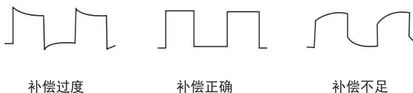
图 4-2 探头补偿校正
